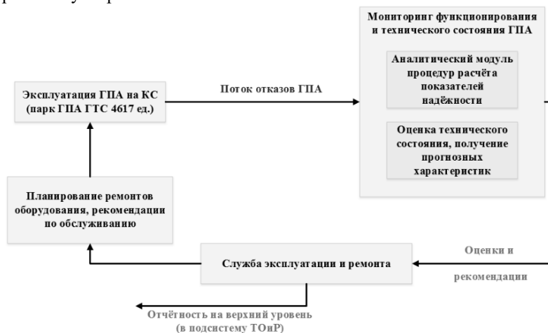
Рисунок 3. Управление целостностью в АСДУ транспортом газа
