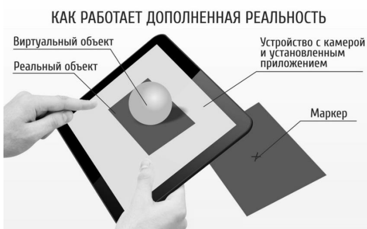
Рис.2 – Пример работы дополненной реальности с использованием координатного маркера
