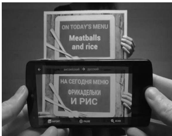
Рис.1 – Процесс возникновения дополненной реальности на примере приложения «Google-переводчик»
